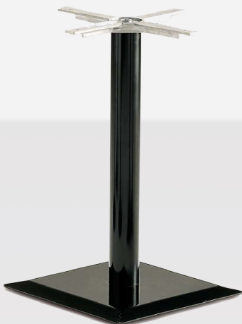
Tischgestell 0000-3191-11 Gestell-Füße: Gußeisen, schwarz lackiert, Gestell-Säule: Metall, schwarz lackiert, Säule rund, ø 8 cm,
